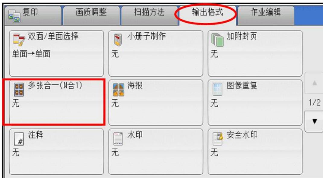
2. 选择[2合1]、[4合1]或者[8合1]，并选择原稿的排版顺序。机器将自动切换成自动倍率和纸盘1，可按需选择纸盘。机器将会把多页原稿合成一页，复印到指定纸张上。
