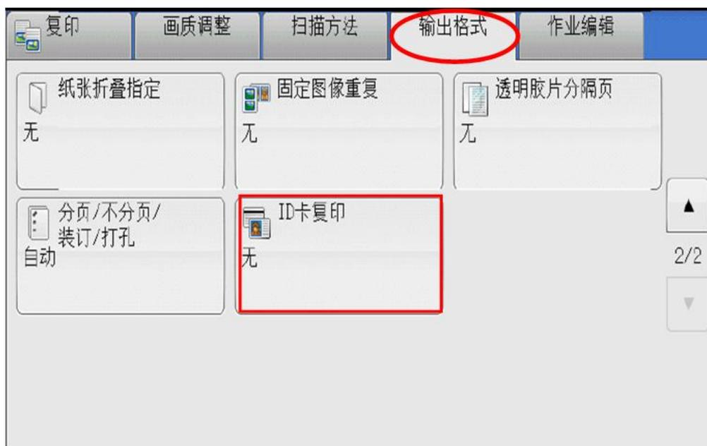
2. 选择[有]，将原稿放置在离稿台玻璃左上角略远的位置，关闭原稿盖，按绿色<启动>键。扫描完第一面后，把证件翻到背面放在相同位置，按绿色<启动>键继续扫描第二面。机器即可把证件的正反面复印在A4纸的同一面上。
