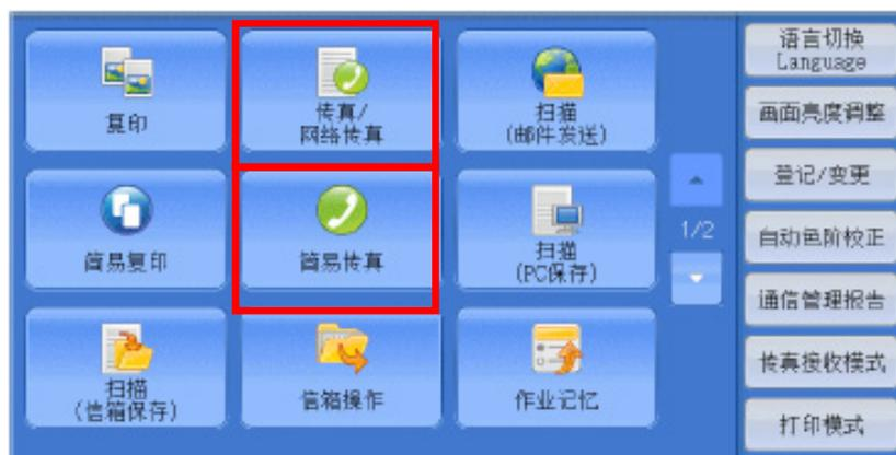
2. 通过控制面板上的<数字键>输入对方的传真号码，或者在通讯簿中指定通信对象，然后选择所需功能如双面原稿输送、发送画质等。按<启动>键，机器将扫描原稿，然后拨号发送传真。
